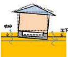
液状化による不同沈下
