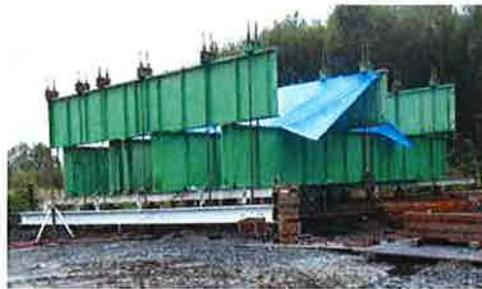
写真-1 載荷試験実施状況
