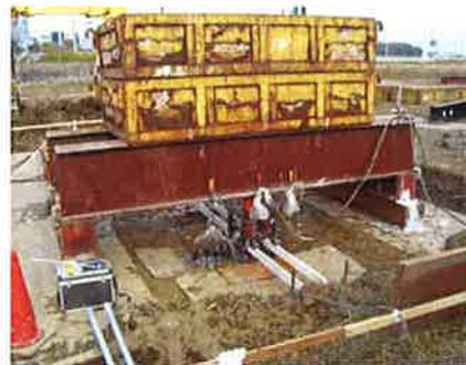
Fig.2 載荷試験状況
