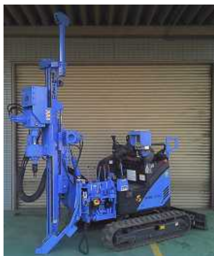
液状化対策地盤調査機
