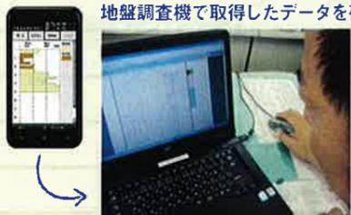
GPS搭載の地盤調査機を使い、現場位置情報、タイムデータ、調査データを作業員のスマートフォン経由でサーバに送信。地盤調査機がデータの整合性を確認。（サムシングの場合）
