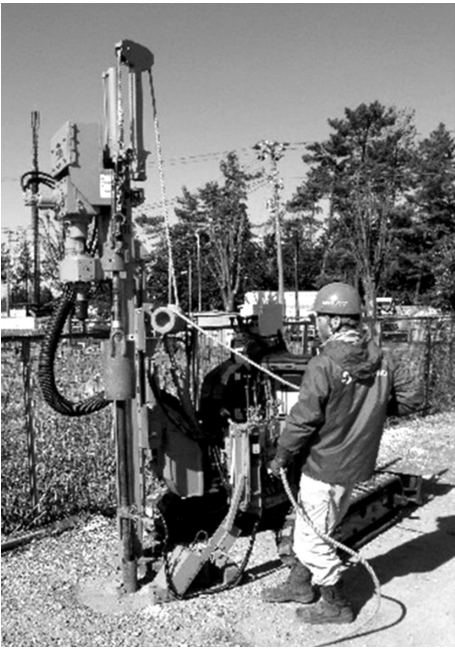
①㈱サムシングが開発したボーリング調査機
