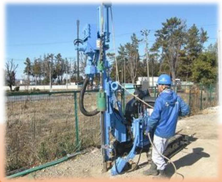
独自開発のボーリングマシン (バイブロ式ボーリング試験)
