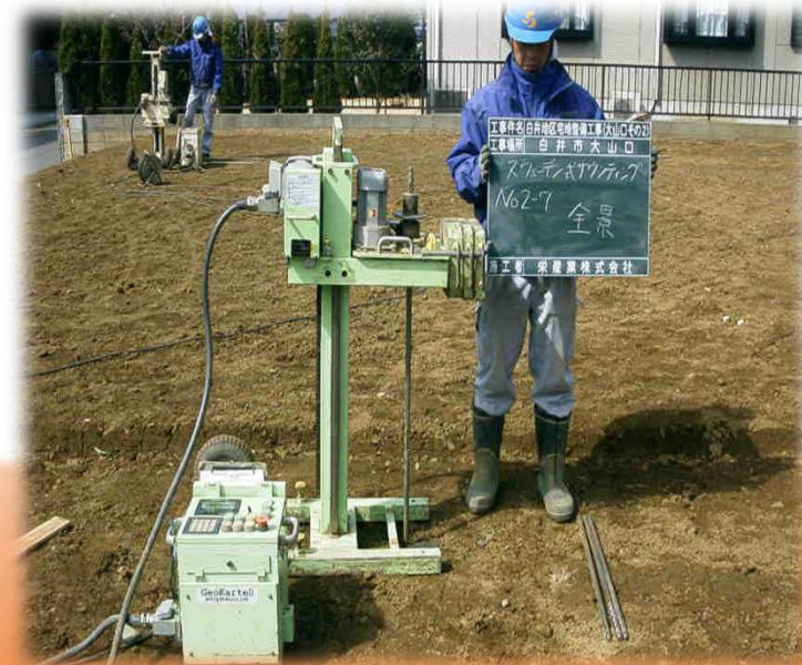
GPS搭載の全自動式調査機 (スウェーデン式サウンディング試験)
