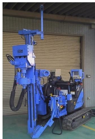
自社開発VDボーリング調査機 「地盤王ホリ・ススム」
